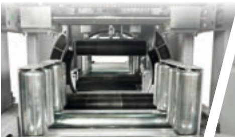
GUÍAS LATERALES DE RODILLOS DE ENTRADA Y SALIDA / GUIAS LATERAIS DE ROLOS EM ENTRADA E SAÍDA
