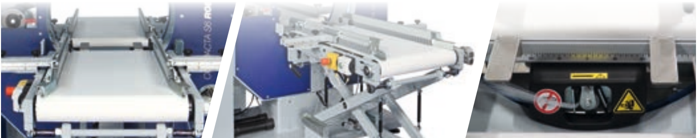
CINTA TRANSPORTADORA HORIZONTAL MOTORIZADA DE ANCHO REGULABLE TRANSPORTADOR HORIZONTAL DE ESTEIRAS MOTORIZADAS DE LARGURA REGULÁVEL
